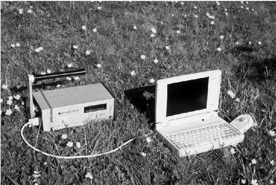
Figura 4. Camera a Ionizzazione AlphaGuard PQ 2000PRO collegata ad un Notebook.
